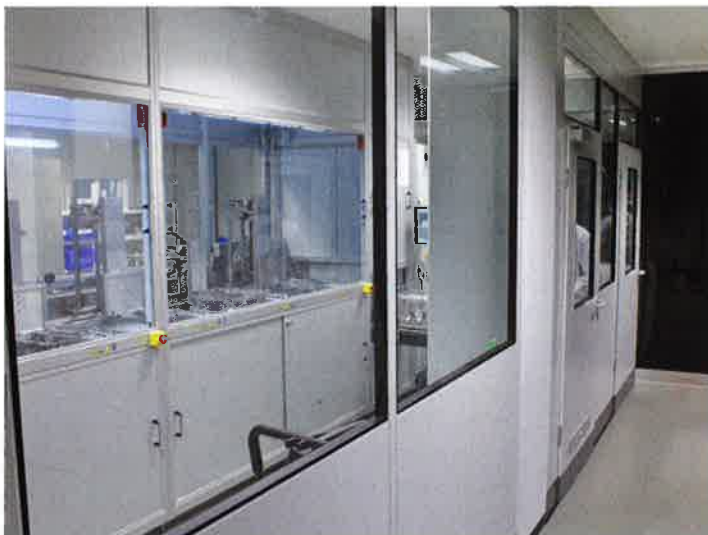
Der Montage vorgelagert und in den Reinraum integriert ist eine 7-Zonen-Ultraschallreinigungsanlage, die das gesäuberte Material direkt in den Montageaum fördert. Sie wurde parallel zum Reinraum beschafft und musste in die Planung integriert werden.
