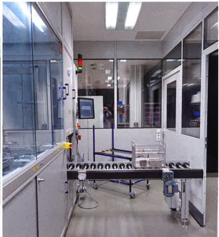
Der Montage vorgelagert und in den Reinraum integriert ist eine 7-Zonen-Ultraschallreinigungsanlage, die das gesäuberte Material direkt in den Montageaum fördert. Sie wurde parallel zum Reinraum beschafft und musste in die Planung integriert werden.
