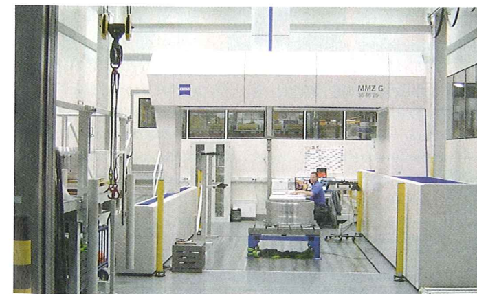
Der Messraum ist mit dem Zulieferbereich über ein Rolltor verbunden. Die damit verbundenen Störungen mussten über eine effektive Luftführung ausgeglichen werden Bild: Renk
