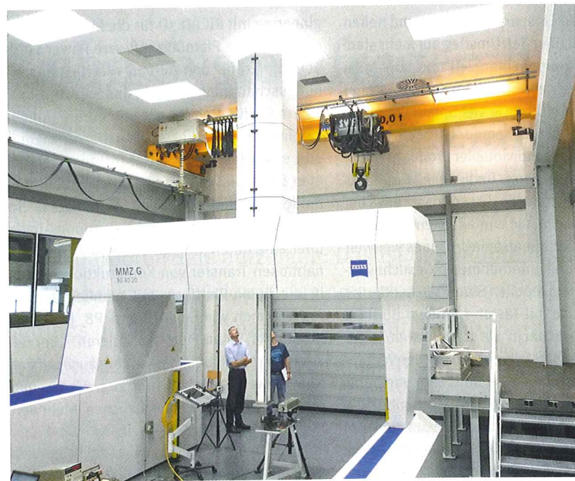
Die Klimatisierung des neuen Messraums bei Renk war eine Herausforderung. Trotz der Höhe des Raums schaffte es der Systemraumhersteller Nerling, den Temperaturunterschied im vorgegebenen Bereich zu halten Bild: Nerling
