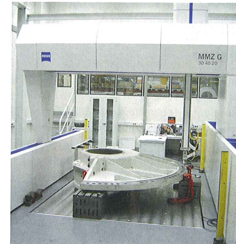
Bei Renk werden mit dem Koordinatenmessgerät von Zeiss vor allem große Gleitlager vermessen. Die geforderte Messgenauigkeit machte eine komplette Einhausung der Messmaschine notwendig Bild: Renk
