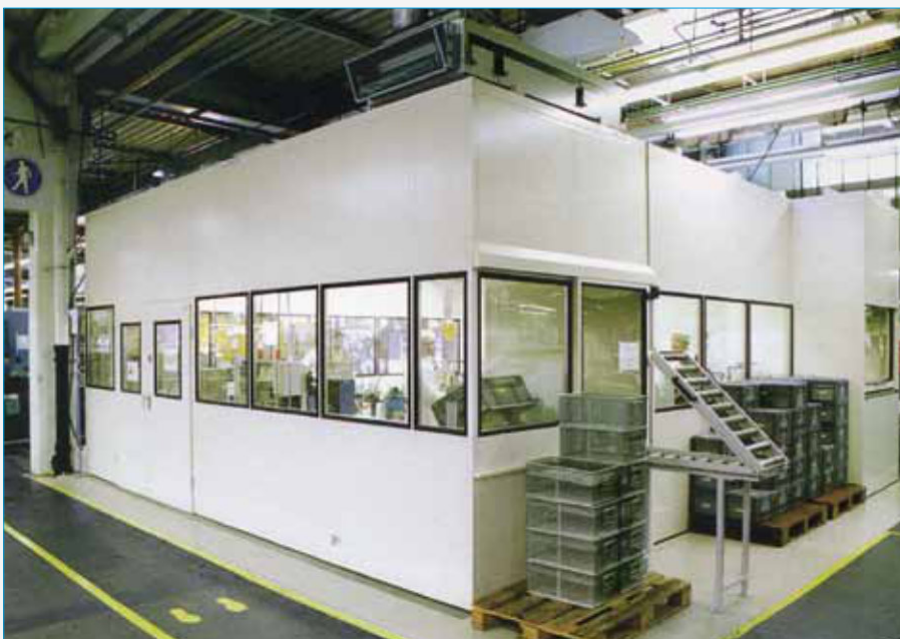
Vielseitige Anwendung: Reinraumkabine mit Doppeltür, die als Fluchttür und für Maschineneinbringung ausgelegt ist sowie eine Materialschleuse mit klappbarer Rollenbahn. Sie kann an eine Teilewaschmaschine angeschlossen werden.
