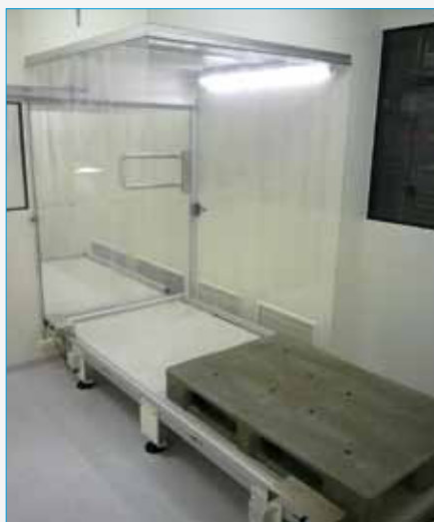
Probenzugkabine mit Laminarflow und Fördertechnik
