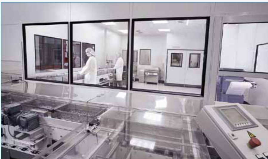
Gekapselte Förderbänder mit Anbindung an den Reinraum
