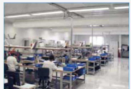
Montage von Miniaturgetrieben im Sauberraum
