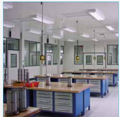
Sauberraum für die Montage von Hochgeschwindigkeitsspindeln
