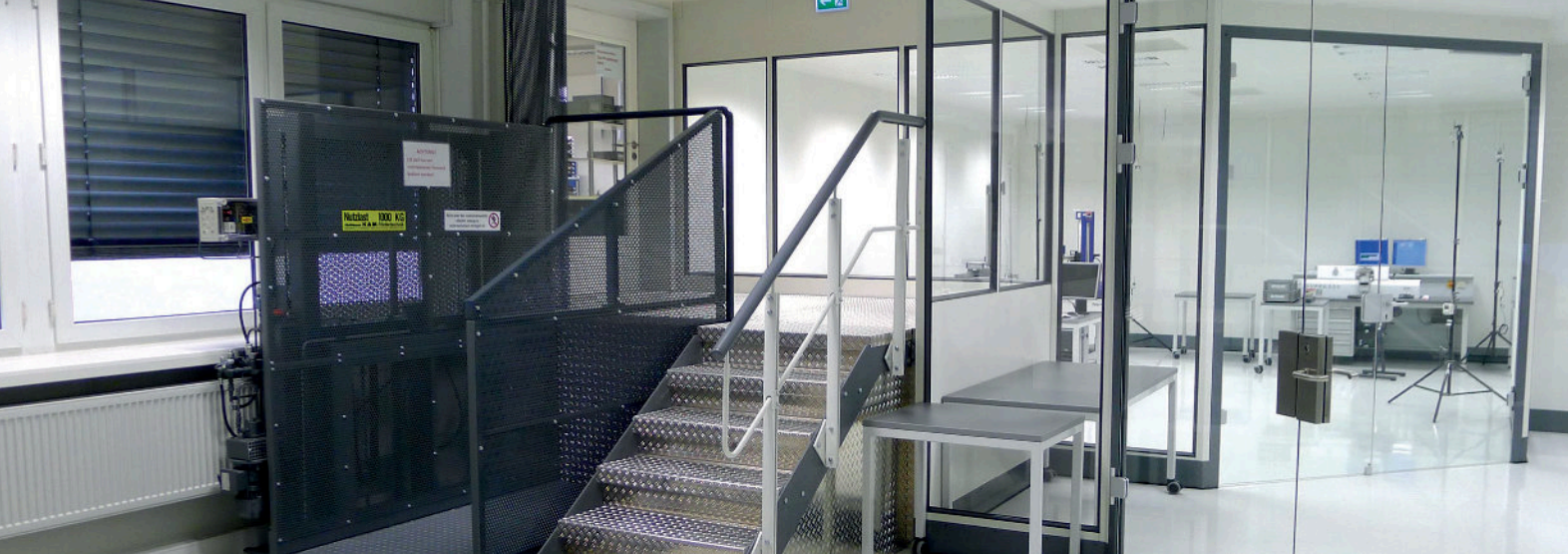
Schlüsselfertiger, klimatisierter Feinmessraum der Güteklasse 2 mit Scherenhublift und Treppenanlage mit Alustufen
