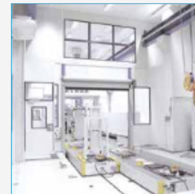
Teiletransport auf Luftkissensystem
