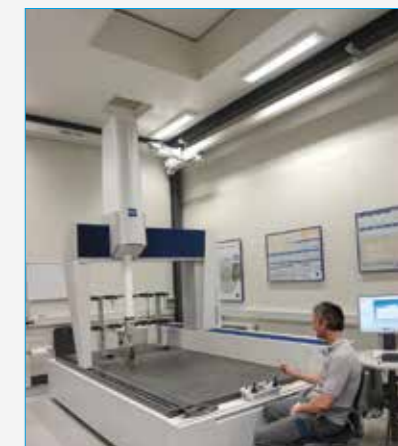
Messraum mit Schiebedach und Brückenkran
